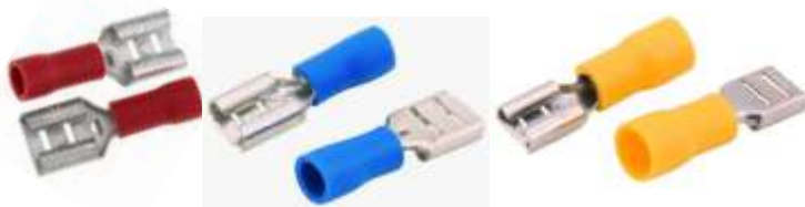
Terminal Pré-Isolado Fêmea 6,3 mm "Faston" Vermelho - 0,5 a 1,5 mm Azul - 1,5 a 2,5 mm Amarelo - 4,0 a 6,0 mm
