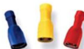
Terminal Isolado Fêmea 6,3 mm "Faston" Vermelho - 0,5 a 1,5 mm Azul - 1,5 a 2,5 mm Amarelo - 4,0 a 6,0 mm
